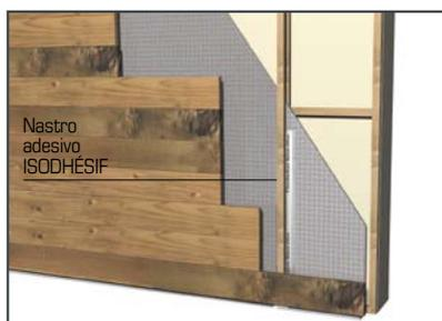
Lasciare una camera d'aria non inferiore a 20 mm da entrambi i lati dell'isolante.
