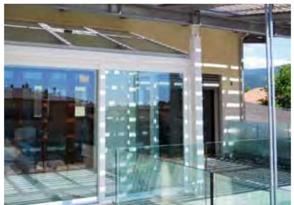
Le Serre sono locali tecnici in grado, quando in inverno il sole è basso sull'orizzonte, di apportare energia solare all'interno dell'appartamento. In estate, al contrario, vanno protette per evitare il surriscaldamento con frangisole, opportunamente studiati.
